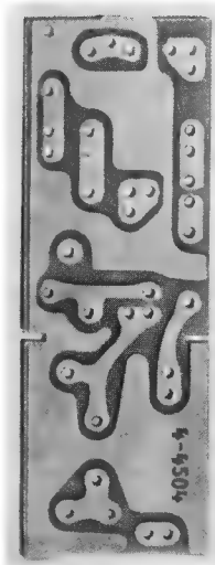
Links: Bild 3. Trägerplatte mit gedruckter Schaltung für die Transistoren und die Hf-Drosseln
